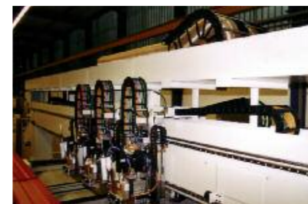
Деревообрабатывающие станки с энергоцепями и кабелями chainflex®
