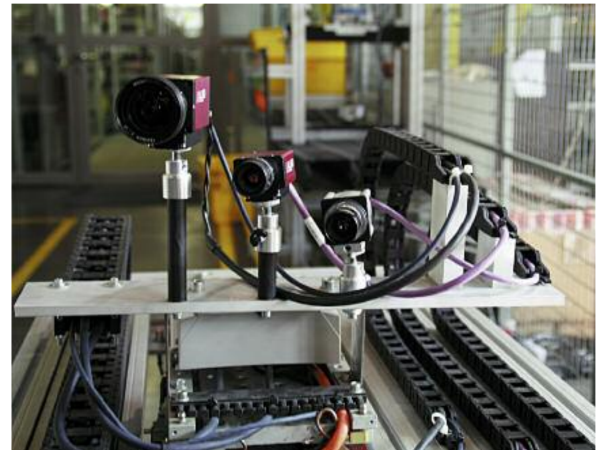
Успешно прошли испытания в энергоцепях e-ketten® с кабелем CFBUS.055 длиной 10 м, более 6,0 миллионов движений.
