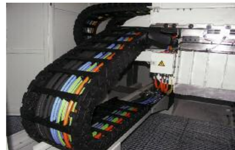
chainflex® измерительные кабели в двухшпиндельном горизонтальном обрабатывающем центре.
