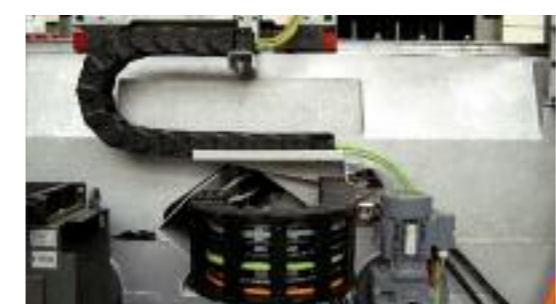
Системы readychain® igus® комплектно сконфигурированные с кабелями chainflex®, шлангами, разъемами, металлическими конструкциями, и т.д.
